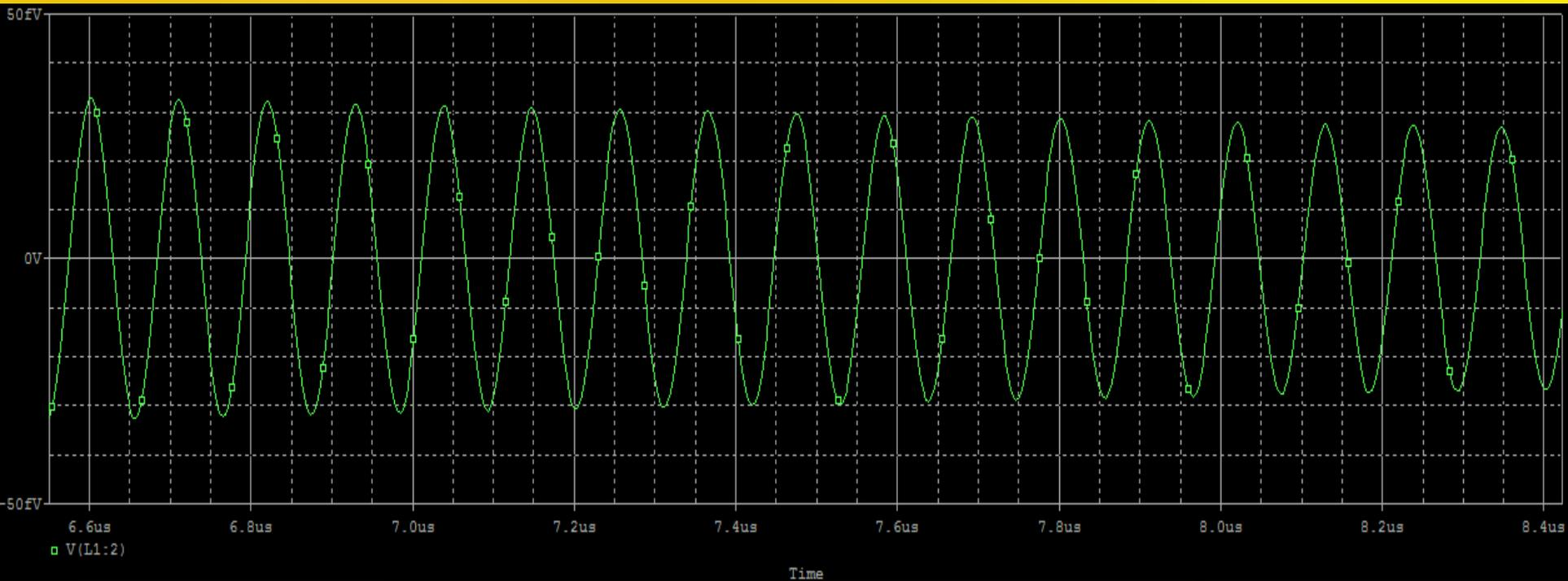
经过理论分析可得电路的振荡频率为10MHz，从得到的SCHEMATIC中得到电路的振荡频率为10MHz左右。
