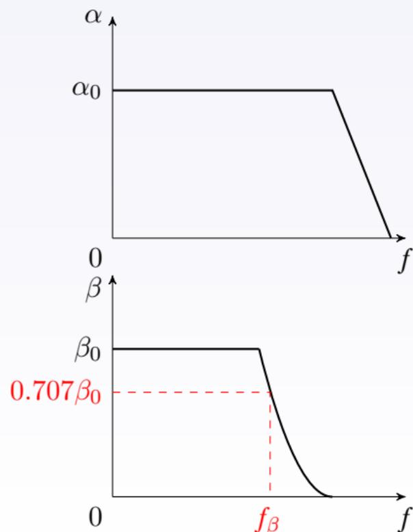
①  $\beta$  截止频率  $f_{\beta} = \frac{1}{2\pi C_{b'e} r_{b'e}}$  是  $\beta$  下降到  $0.707\beta_0$  时的频率。
