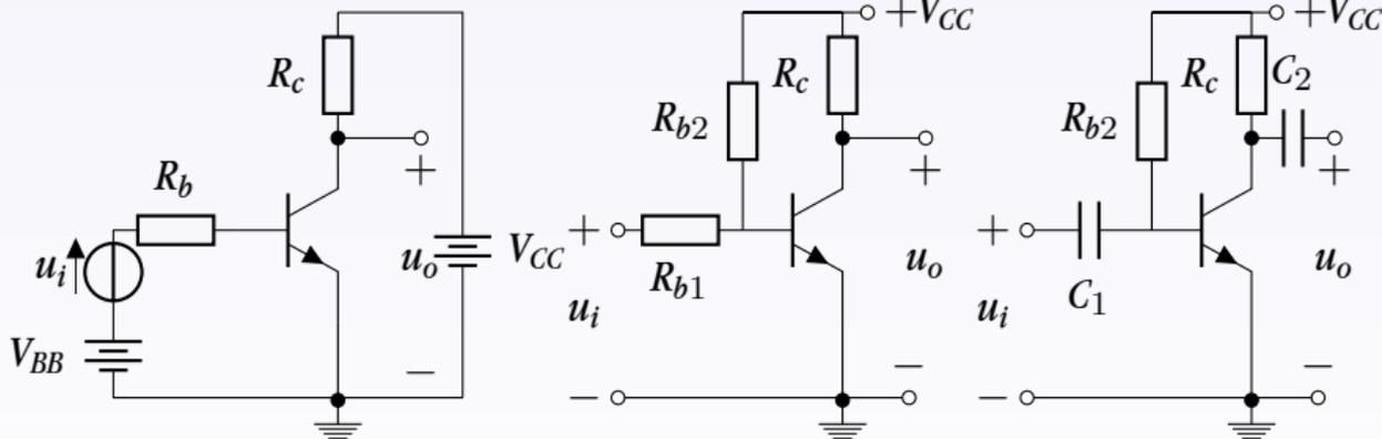
**截止区** 发射结电压小于开启电压且集电结反向偏置（开关断开）
