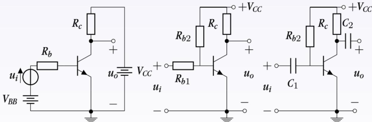
**输入回路** 输入的电压信号  $u_i$  接入基极—发射极回路；
